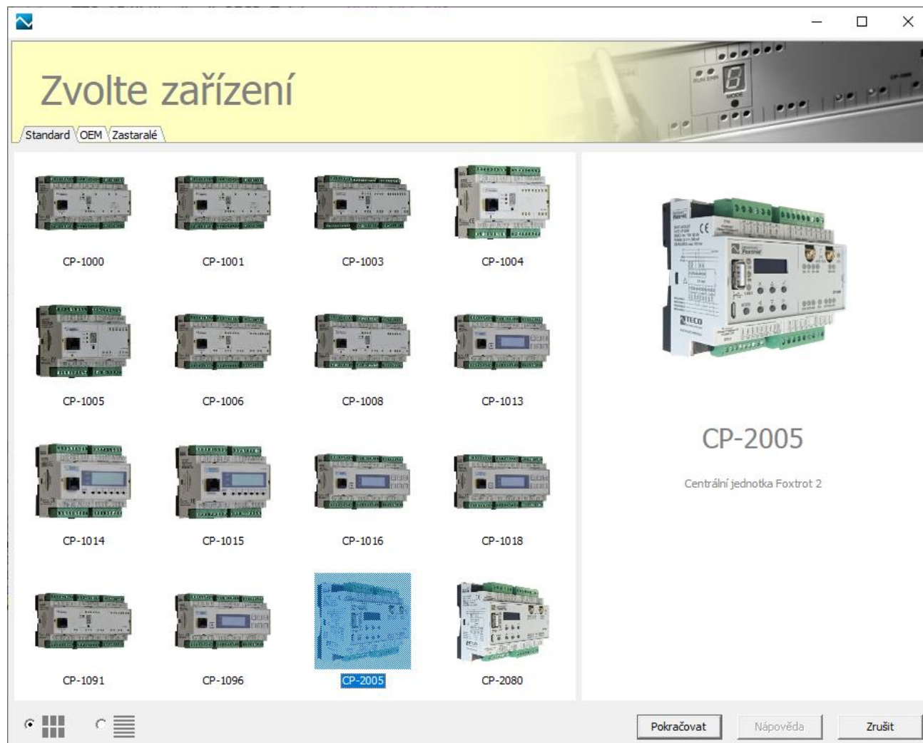
Obr.7.3 Výběr základních modulů PLC
