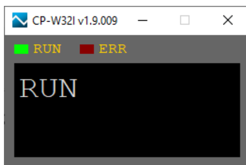
Obr.3.21 Okno simulátoru PLC v prostředí Mosaic
